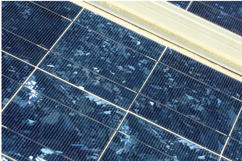
FIGURA 4.5 – Aspecto característico de células de silício policristalino, com partes claras devidas aos diversos cristais que compõem a estrutura do material.
